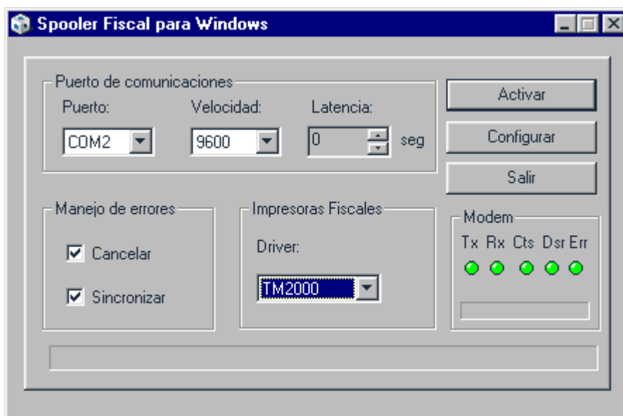
Figura 2: Configuración de los parámetros principales
